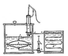
図3 Jacob Perkins の動力駆動冷凍機
