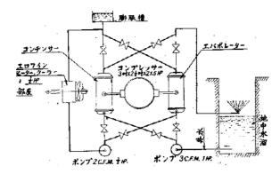
図 12 我が国初のヒートポンプ式暖房の系統図
