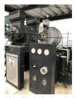
図1 現存する最古の高砂荏原式ターボ冷凍機 (高砂熱学工業 技術研究所 所蔵)
