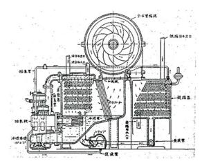
図8 高砂荏原式ターボ冷凍機の構造図
