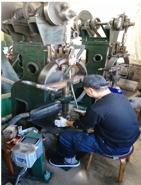
図 22 箔打ちの様子
