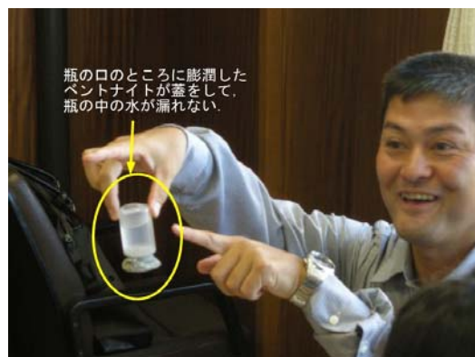
図2 興味をもってもらおうためのデモ実験(ベントナイトの遮水性能の見える化実験)
