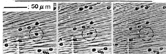
b-1) b-2) b-3) b)氷結晶との相互作用による赤血球の破壊例 (H=3.17°C/min,G=20.0°C/mm,V=0.16mm/min)
