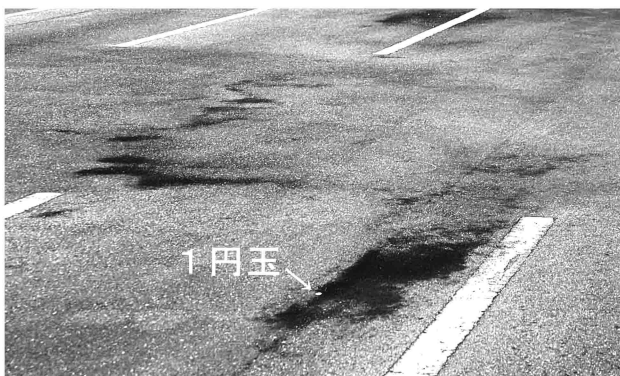
写真: 飯館村の「真黒」な高放射線土 2012年4月30日。ここでは地上1cmで8万cpm。
