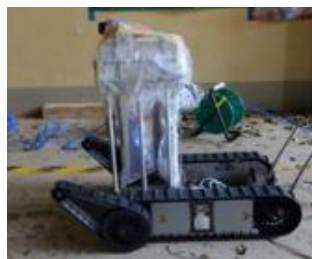
小型コンプトンカメラ (上) とカメラを搭載したロボット (下)
