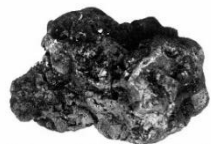
スリーマイル原発事故時の燃料デブリ試料
